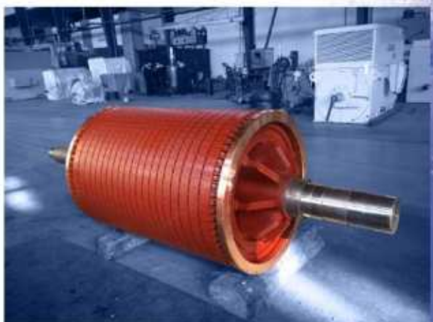
روتور مورد استفاده در الکتروموتورهای فشار متوسط
