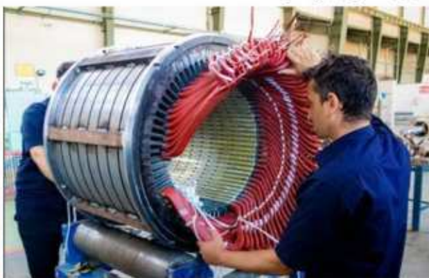
استاتور مورد استفاده در الکتروموتورهای فشار متوسط
