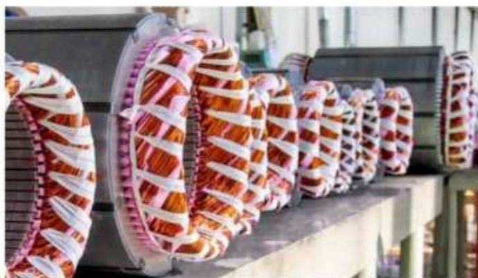
استاتور مورد استفاده در الکتروموتورهای فشار ضعیف
