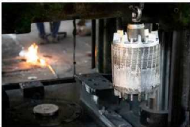
روتور مورد استفاده در الکتروموتورهای فشار ضعیف
