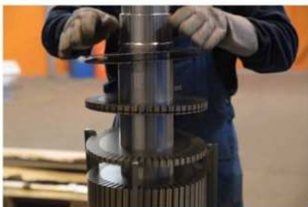
روتور مورد استفاده در الکتروموتورهای فشار ضعیف
